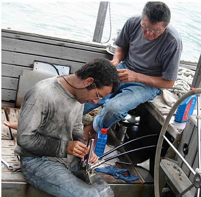
Die Crew fährt am anderen Tag in ein nahes Tierreservat. Sie sehen Nashörner, Löwen, Strausse aber keine Elefanten. Ich versuche am Abend nochmals zu entlüften, da bricht — wie wir später sehen — der Bolzen, der die Dichtung im Zylinder auf der Schubstange hält. Die Stahlspäne zerkratzen die Schubstange. John und ich
